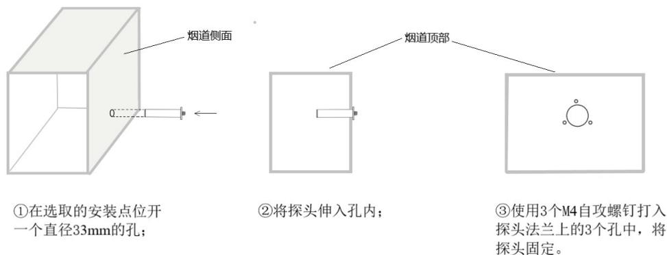
**安装分体式类型的监控仪的探头：**安装前检查探头应完好无损，探头上的各组成部件之间应紧密连接无松动。安装时先在选取的安装点开一个直径50mm的孔，将探头伸入孔内，然后将探头调整为正方向(使探头排气孔垂直于地面)；然后使用5个M4自攻螺钉打入探头外壳上的5个孔中，将探头固定。然后将探头上的引出线穿过电工套管后从监控仪底部的接入孔接入监控仪内部主控制板上的右/左烟道的接入端子，按照**6、接线方式**中的方法接
